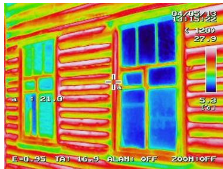
Рис. П.13. Наружные ограждающие конструкции в хорошем состоянии, температурные перепады связаны с нарушением переплетов оконных проемов.
